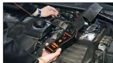
Per effettuare la **diagnosi dei singoli componenti** dell'impianto elettrico è sufficiente avvicinare la sonda al componente in esame. In impianti con componenti elettromeccanici/elettronici comandati da una centralina, lo strumento permette di verificare se:
