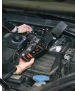
Per effettuare la diagnosi dei singoli componenti dell'impianto elettrico è sufficiente avvicinare la sonda al componente in esame.
