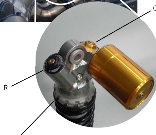
Anelli di regolazione del precarico della molla
