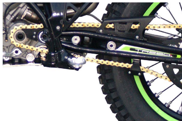
Catena di trasmissione e molle del tensore
