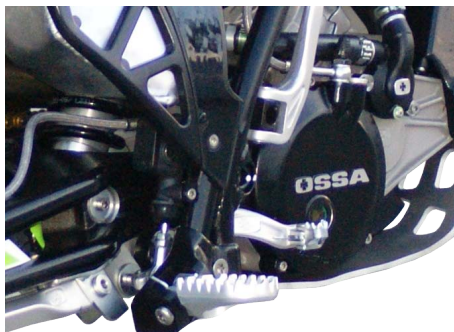
Dispositivi di ssaggio e molle delle stae
