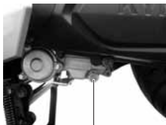
Vite di drenaggio (2)
