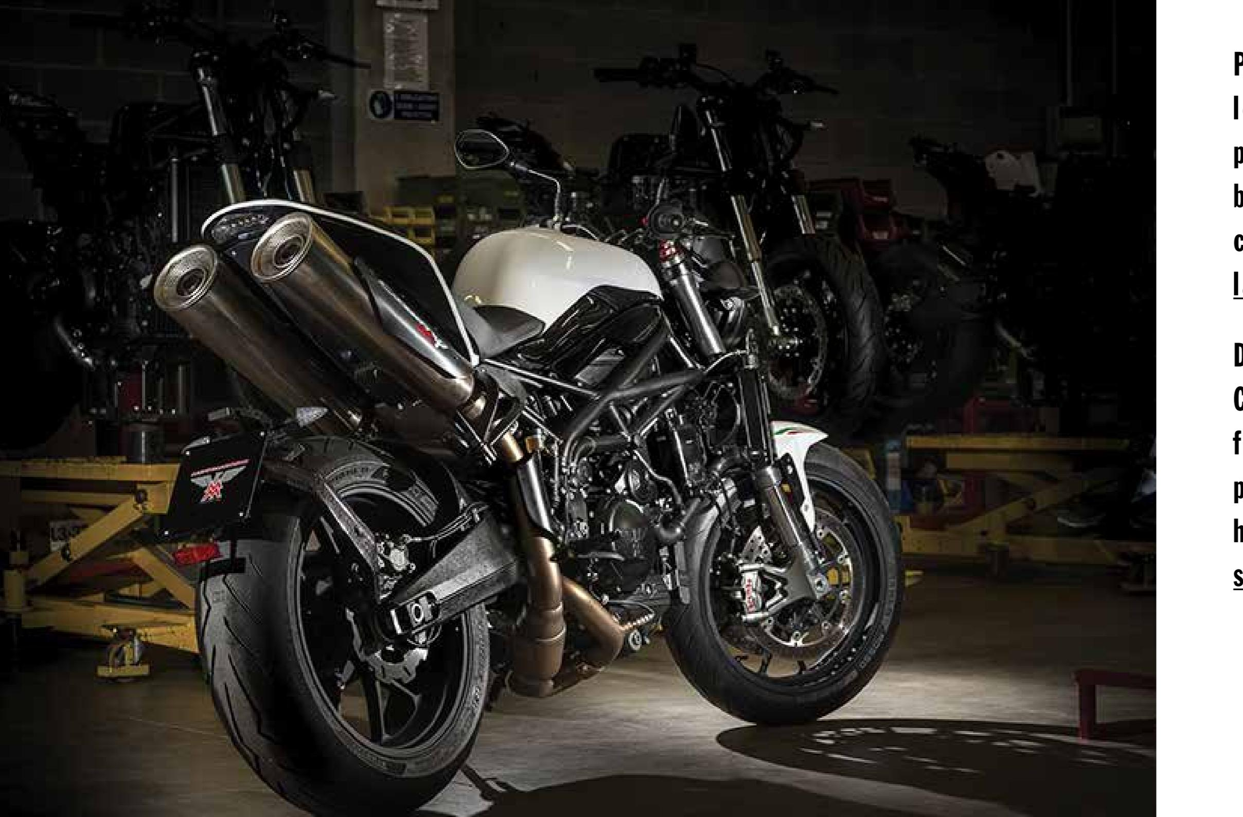
Progettate secondo le specifiche volute da Moto Morini per la Corsaro ZT, le nuove sospensioni sono firmate Mupo. La forcella con piedini ricavati dal pieno è regolabile in compressione, estensione e precarico consentendo ben 135 mm di corsa, utili a coniugare la stabilità alle alte velocità con il comfort nella guida disimpegnata. Il nuovo setting dell'ammortizzatore rende la moto più confortevole e adatta all'uso quotidiano.
