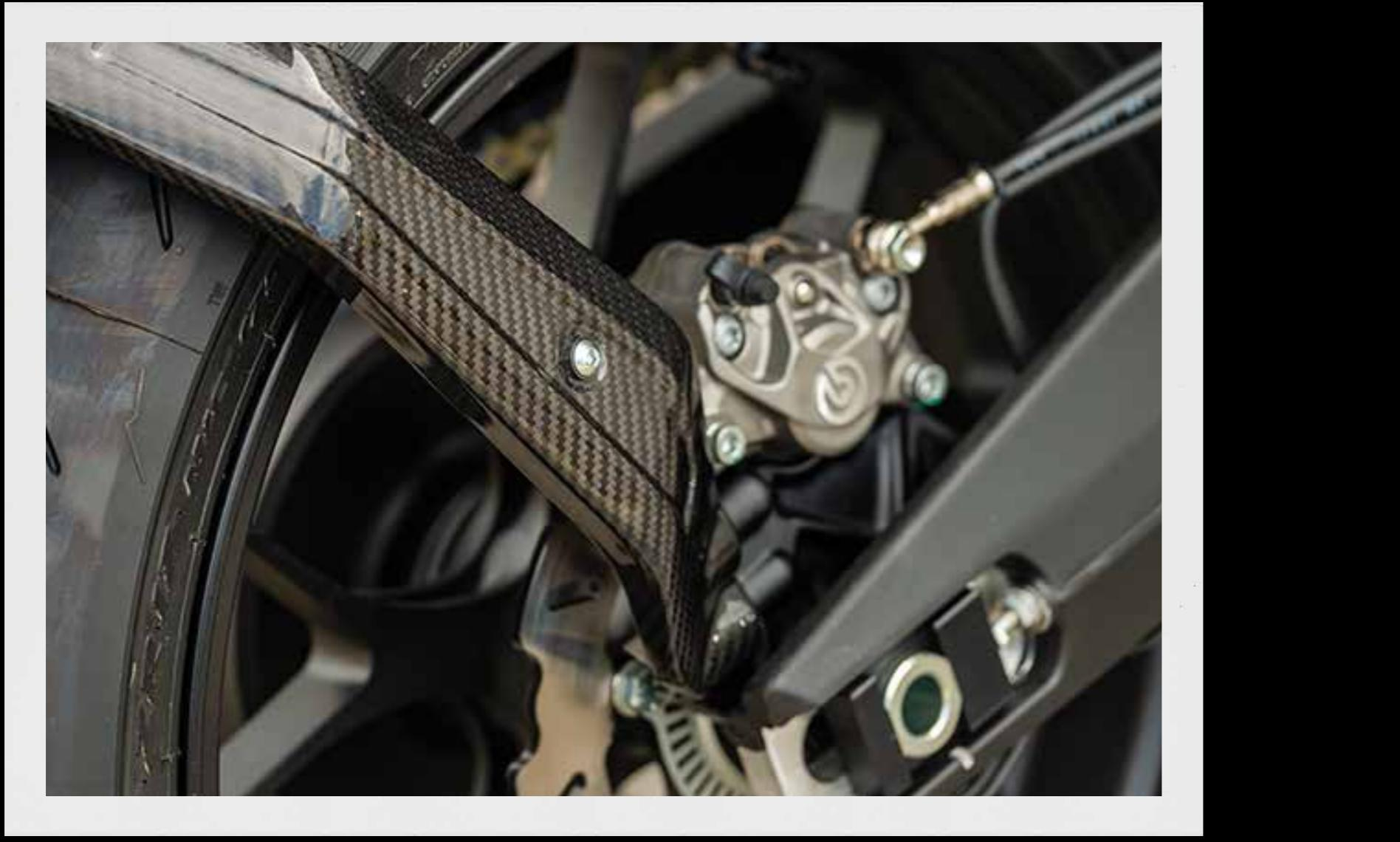
L'impianto frenante con ABS disinseribile può contare all'anteriore su pinze radiali monoblocco a quattro pistoncini, doppio disco flottante da 320 mm ed una pompa semi-radiale 16/19, tutto firmato Brembo; al posteriore, pinza a due pistoncini con disco da 220 mm dal disegno specifico.
