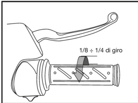
Se dopo 3-4 secondi il motore non si avvia ruotare leggermente la manopola dell'acceleratore ( $1/8 \div 1/4$  di giro). Nel caso lo scooter sia rimasto fermo per alcuni giorni il motore potrebbe non partire immediatamente. In questo caso è necessario ruotare leggermente l'acceleratore e ripetere la procedura di avviamento più volte.
