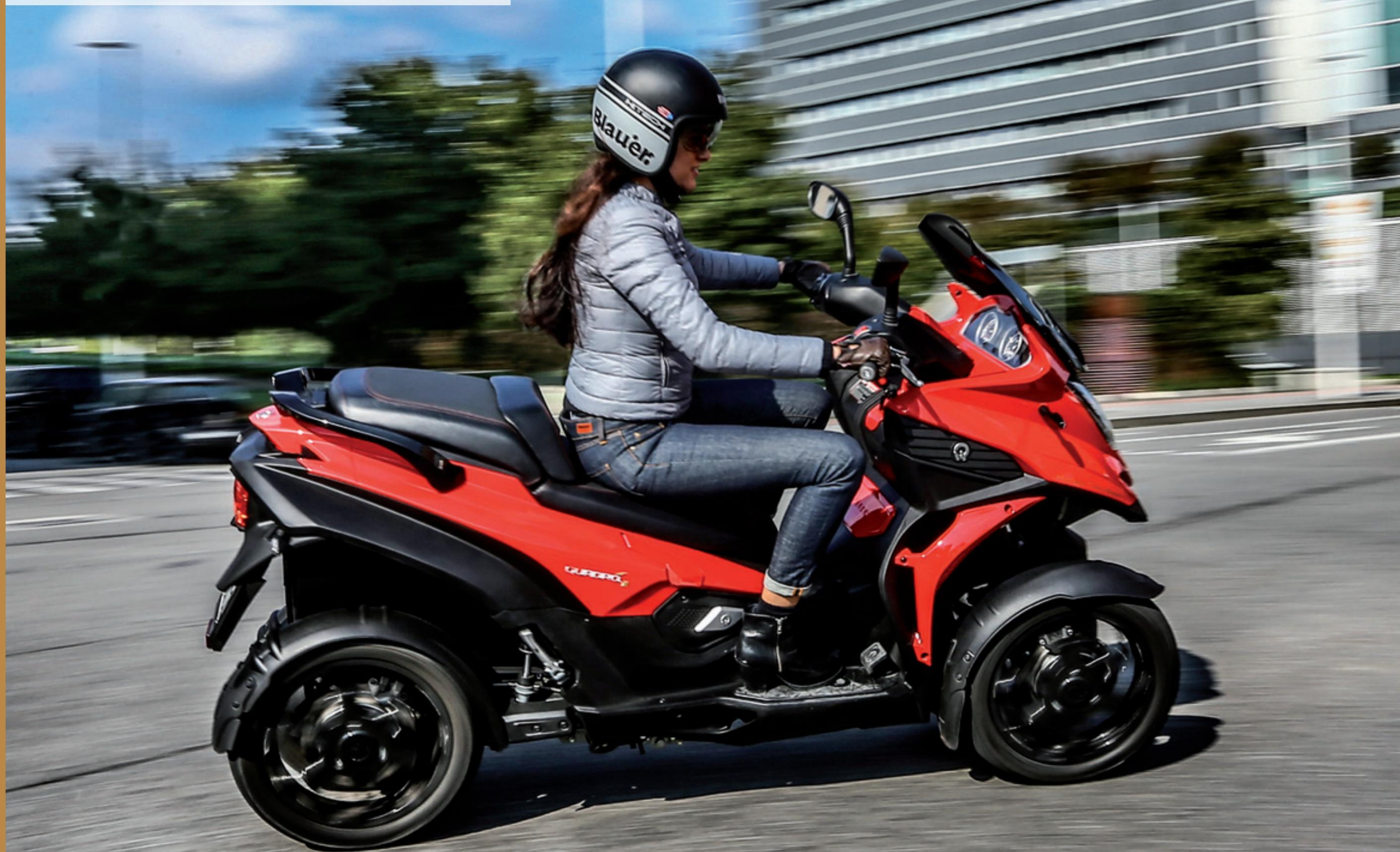
**QUADRO4** è confortevole per conducente e passeggero. È spinto da un motore monocilindrico montato centralmente, con doppio contralbero e differenziale integrato per consentire una drastica riduzione delle vibrazioni.
