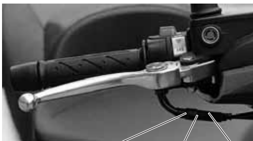
Controdado (3) Vite di regolazione (2) Manicotto in gomma (1)
