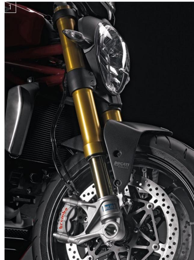
1. Preziosa forcella Öhlins da Ø 48 mm, impianto freni di derivazione racing e parafango in carbonio / Refined Ø 48 mm Öhlins fork, racing-derived brake system and carbon mudguard
