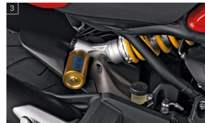
3. Ammortizzatore posteriore Öhlins completamente regolabile / Fully adjustable Öhlins rear shock
