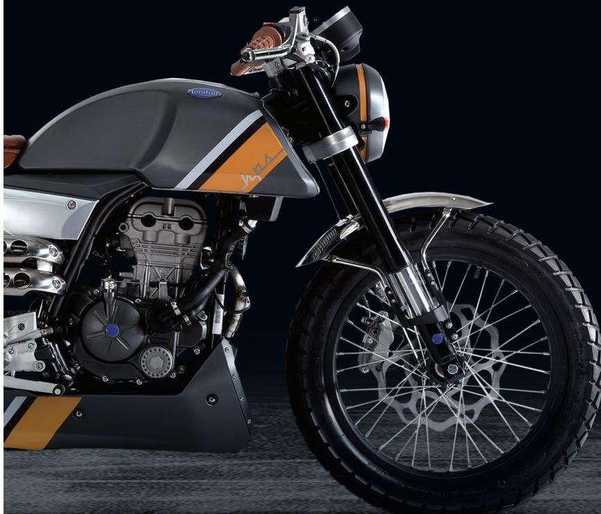
Il design della HPS 125 è la perfetta fusione delle caratteristiche classiche di F.B.Mondial e dell'anima tecnologica fornita da un propulsore di 125cc DOHC, dotato di iniezione elettronica e raffreddamento a liquido.
