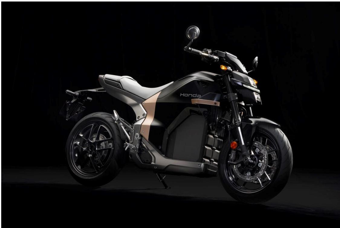
Caratteristiche nuovo modello: **Honda lancia la sua prima moto elettrica. La futuristica WN7 grazie a una combinazione di: pacco batteria da 9,3 kWh, motore raffreddato a liquido con un picco di potenza di 50 kW, coppia massima di 100 Nm e la trasmissione finale a cinghia che riduce gli attriti, offre un'autonomia di 140 km (ciclo medio WMTC).**
