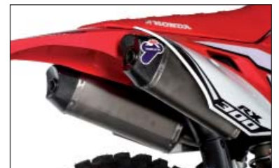
Impianto di scarico Termignoni inox con silenziatori in titanio e fondelli in carbonio
