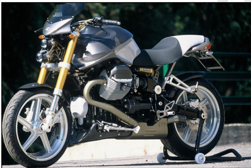
Esteticamente, tra le altre particolarità, spicca il design del telaio posteriore che è stato anch'esso realizzato in titanio e che presenta visibili saldature dovute all'impossibilità di piegare il materiale con angoli ristretti; questo elemento è l'emblema dell'unione tra la raffinatezza del materiale utilizzato e il carattere forte e aggressivo del modello Furia, che ne esce ancora più vincente!
