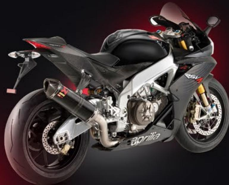
Il cupolino alto termoformato aumenta la penetrazione aerodinamica e la protezione dalle turbolenze ad alte velocità. L'ammortizzatore Öhlins TTX completamente regolabile, ha punti di attacco ricavati dal pieno. Le pedane in alluminio, anch'esse interamente ricavate dal pieno, sono regolabili in 9 differenti posizioni e permettono la calibrazione micrometrica dei comandi cambio e freno.
