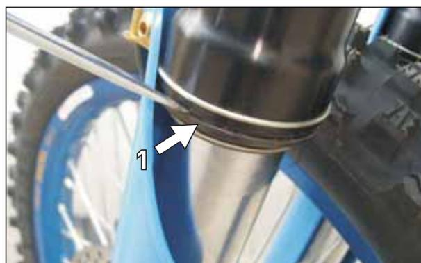
Pulire con cura il raschiapolvere (1), il fodero (2) e lo stelo (3) ed oliarli bene con spray al silicone o con olio motore. Infine rimontare il raschiapolvere spingendolo a mano nella sede nel fodero.
