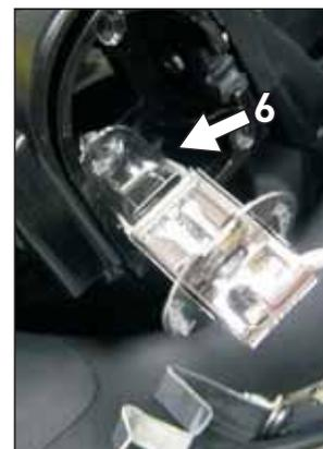
**SOSTITUZIONE LAMPADA FARO ABBAGLIANTE**
