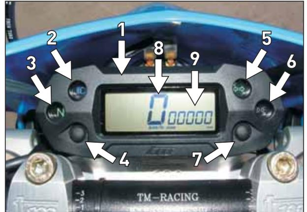
L' unità di misura del tachimetro e del contakm parziale e totale è il Km/h ma può essere settato in Mph nel seguente modo: premere contemporaneamente il pulsante ADJUST e il pulsante SELECT per 3 secondi. L' unità di misura corrente apparirà lampeggiante. Premere il pulsante ADJUST per cambiare da Km/h a MPH o viceversa.
