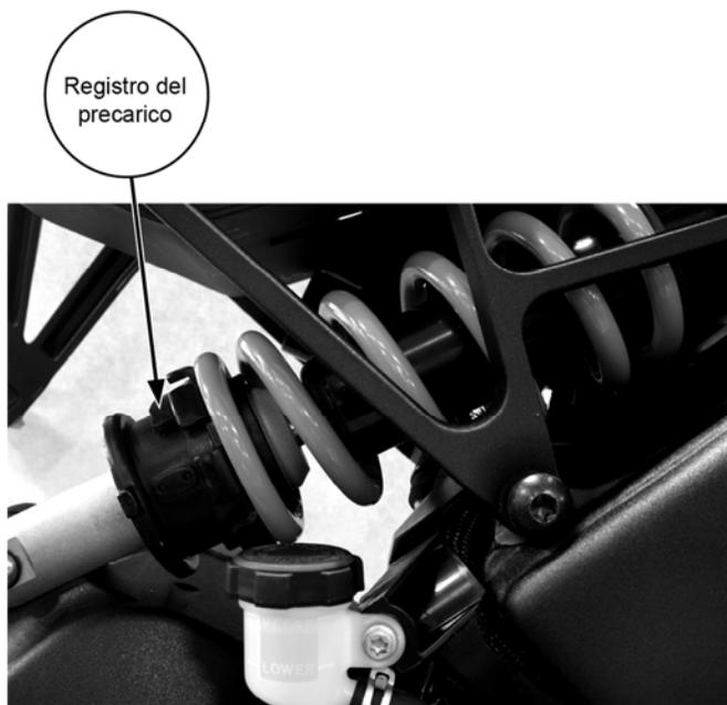
Figura 26. Registo del precarico posteriore.
