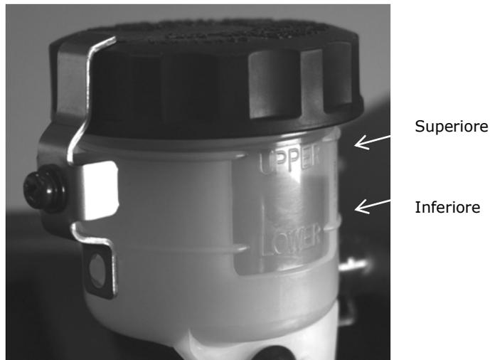
Figura 38. Serbatoio del liquido dei freni anteriore.
