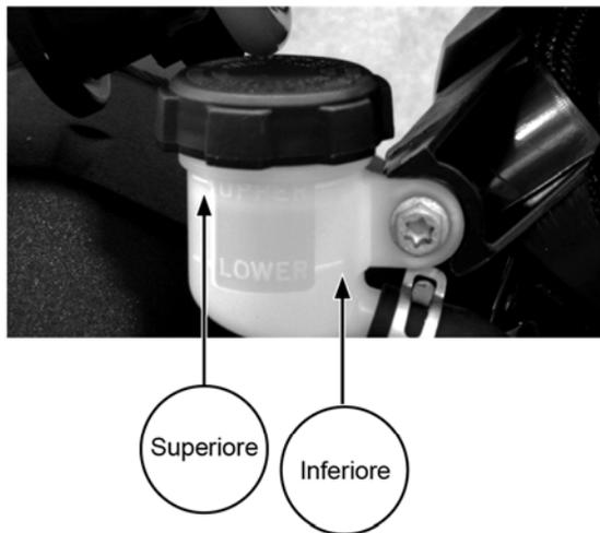
Figura 39. Serbatoio del liquido dei freni posteriore.
