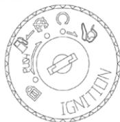
L'interruttore di avviamento/bloccasterzo comanda l'impianto di avviamento e l'impianto di illuminazione e viene utilizzato per bloccare lo sterzo. Qui di seguito sono riportate le varie posizioni.
