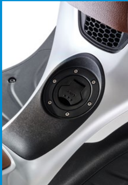
TAPPO SERBATOIO SUL TUNNEL CENTRALE
