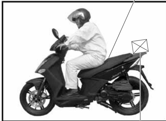
Massimo carico per il vano sottosella: 5 kg.
