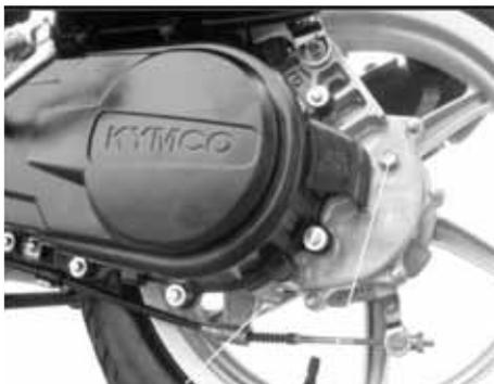
(2) Vite di drenaggio      (1) Vite di ispezione
