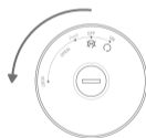
Inserire la chiave e ruotare in posizione LOCK per bloccare lo sterzo del manubrio
