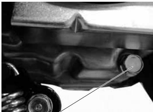
Vite di drenaggio
