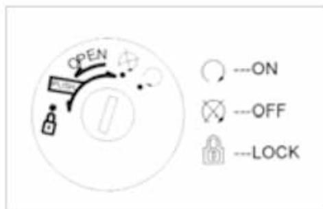
Posizionare la chiave di avviamento nella posizione "ON" prima di avviare il motore. Una volta spento il motore posizionare la chiave di avviamento nella posizione "OFF". Posizionare la chiave di avviamento nella posizione LOCK premendo e ruotare il manubrio verso sinistra per innestare il bloccasterzo
