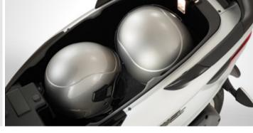
Il **vano sottosella**, dotato di presa 12v, luce di cortesia, tappetino antiurto e copertina sella antipioggia, è ancora più accessibile e sfruttabile; al suo interno possono trovare spazio comodamente due caschi integrali.
