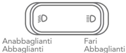
Osservazioni: Per segnalare il sorpasso con luce lampeggiante, il conducente può premere ripetutamente e rilasciare la parte sinistra del pulsante.
