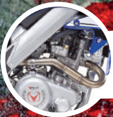
Carburatore Keihin CVK a valvola piatta diametro 30 mm Keihin CVK flat slide carburetor diameter 30 mm
