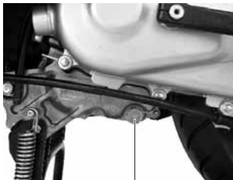
Vite di drenaggio
