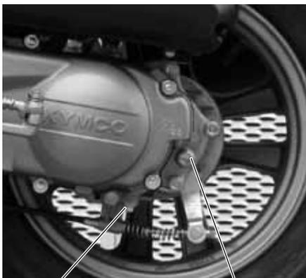
(2) Vite di drenaggio (1) Vite di ispezione
