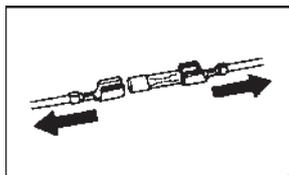
Estrarre il fusibile da sostituire
