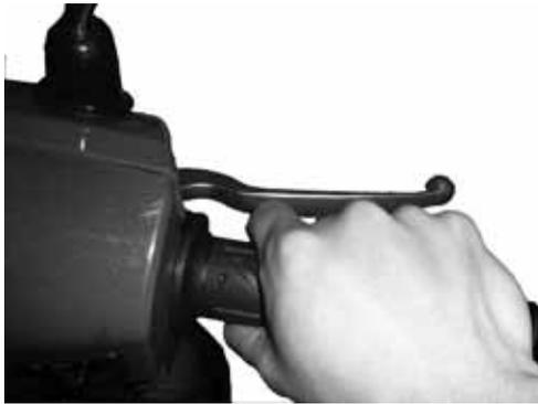
Se dopo 3-4 secondi il motore non si avvia ruotare leggermente la manopola dell'acceleratore ( $1/8 \div 1/4$  di giro).
