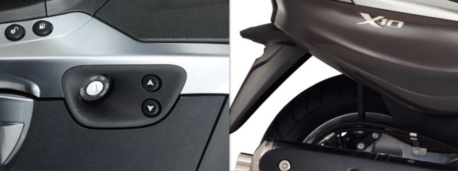
Regolazione elettrica continua del monoammortizzatore posteriore che ottimizza l'assetto in funzione del carico sul veicolo (solo 500 ie)
