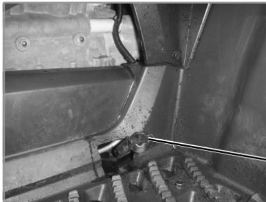
Premendo il pedale del freno si aziona la frenata integralmente sulle quattro ruote. Questo dispositivo va considerato come freno principale di servizio.
