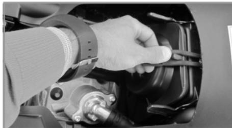
Pulizia del filtro aria: accedete al vano sotto la sella, slacciate la linguetta in gomma dalla cassa filtro in modo da poterlo rimuovere. Sfilate con attenzione il coperchio della cassa e successivamente il filtro. Se la cassa risulta particolarmente piena di sporcizia ed umidità, ef-
