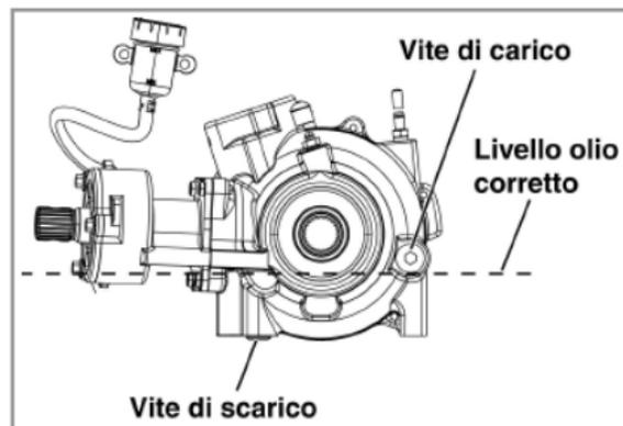
Durante il controllo del livello verificate che non vi siano apparenti perdite o trafileamenti dagli alberi, dai tappi o dalle tenute. L'aspetto del lubrificante non deve essere lattiginoso: fluido denso, schiumoso, non trasparente è sintomo di immissione di acqua nel lubrificante con possibili gravi guasti alla trasmissione. Controllate inoltre con regolarità che il cavo di collegamento elettrico per l'inserimento della trazione integrale (4x4) sia integro.
