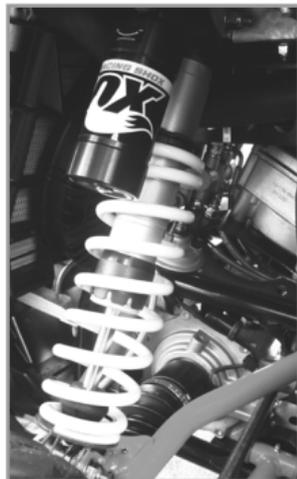
**!** **ATTENZIONE** Ispezionate regolarmente i corpi delle sospensioni: tracce di olio sugli steli o, peggio ancora, sul corpo dei cilindri idraulici indicano malfunzionamenti dei gruppi sospensioni. Fate effettuare al più presto una revisione o una sostituzione dei gruppi ammortizzatori, rivolgendovi ad un concessionario o ad un rivenditore
