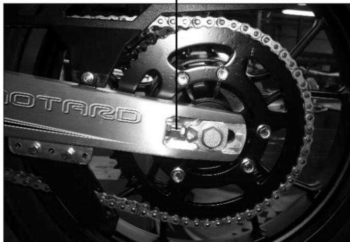
Cercare di non tendere troppo la catena in quanto si possono produrre danni al motore e alla trasmissione; mantenere la tensione della catena nei limiti specificati negli schemi in allegato.
