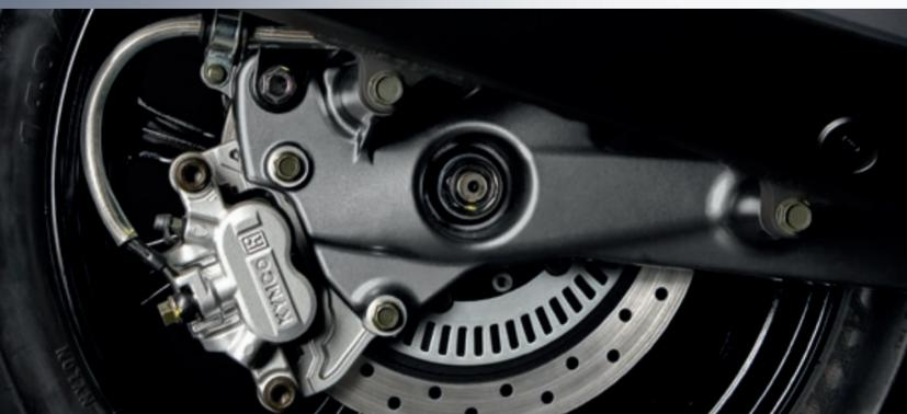
IL CERVELLO DEL SISTEMA ABS È COSTITUITO DA UNA CENTRALINA ELETTRONICA AD ALTA VELOCITÀ DI CALCOLO CHE CONTROLLA LO STATO DI ENTRAMBI I FRENI E COMANDA UN RIPARTITORE IDRAULICO DI PRESSIONE. LA CENTRALINA ABS ESEGUE IL COSTANTE MONITORAGGIO DEI SENSORI CHE TRACCIANO E VERIFICANO LA VELOCITÀ DI ROTAZIONE DELLE RUOTE FONICHE DEI DUE CERCHI. IN CASO DI SCARTO DI VELOCITÀ TRA LA RUOTA ANTERIORE E
