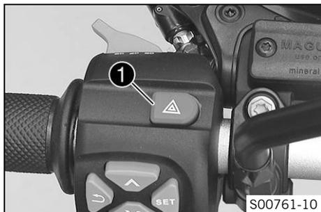
L'interruttore del lampeggio d'emergenza **1** è situato a sinistra sull'interruttore combinato. L'impianto del lampeggio d'emergenza viene utilizzato per segnalare la presenza di situazioni d'emergenza.
