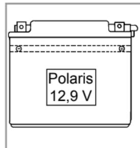
Installazione della batteria: pulire i morsetti di collegamento ed i cavi, serrare i morsetti senza eccessiva tensione, prima la polarità positiva (+, rosso) poi il cavo di massa (-, nero). Cospargere i morsetti con del grasso bianco idrorepellente.
