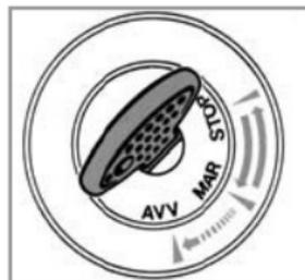
to in posizione **"AVV"** per un massimo di 5 secondi senza agire sulla manopola dell'acceleratore. Lasciate girare il motore per qualche istante fino a quando non si avverta una rotazione libera e regolare e, se necessario, sostenete il motore ad un regime leggermente accelerato con il gas, fino a quando il quadriciclo mantenga regolarmente il regime del minimo senza particolari attenzioni.
