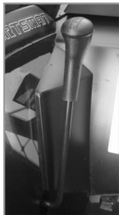
L'utilizzo della marcia avanti lenta è consigliabile in situazione di massimo sforzo, non mantenete questo rapporto inserito più a lungo del necessario per non usurare la trasmissione a cinghia. Per cambiare marcia, arrestare il veicolo, portare il motore al minimo ed inserire il rapporto desiderato.
