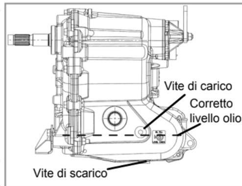
della filettatura della sede per la vite di carico. Se necessario rabboccate con Polaris Premium Synthetic Gearcase Lubricant o AGL Synthetic Gearcase Lubricant. Durante il controllo del livello verificate che non vi siano apparenti perdite o trafileamenti dal cambio, dai tappi o dalle tenute. L'aspetto del lubrificante non deve essere lattiginoso: fluido denso, schiumoso, non trasparente è sintomo di immissione di acqua nel lubrificante con possibili gravi guasti alla trasmissione.
