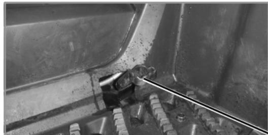
Premendo il pedale del freno si aziona la frenata integralmente sulle quattro ruote. Questo dispositivo va considerato come freno principale di servizio.
