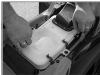
Sfilate il pre-filtro aria ed il filtro aria. Lavate il pre-filtro aria con acqua tiepida e sapone neutro, fatelo asciugare **SENZA STRIZZARLO** lontano da fonti di calore. Soffiate dall'interno al
