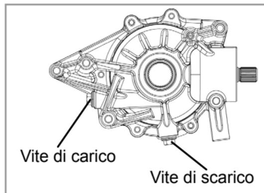
Durante il controllo del livello verificate che non vi siano apparenti perdite o trafilamenti dagli alberi, dai tappi o dalle tenute. L'aspetto del lubrificante non deve essere lattiginoso: fluido denso, schiumoso, non trasparente è sintomo di immissione di acqua nel lubrificante con possibili gravi guasti alla trasmissione. Controllate inoltre con regolarità che il cavo di collegamento elettrico per l'inserimento della trazione integrale (4x4) sia integro.
