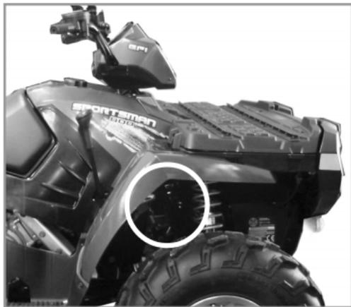
Rimuovere la copertura del vano anteriore, verificare il livello nel serbatoio. Se il livello è sotto il contrassegno minimo, rimuovere la protezione e aggiunge il fluido relativo Polaris ADC. Reinstallare la protezione e la copertura del vano anteriore.
