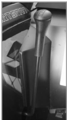
Premente il comando freno principale, posizionare il cambio in prima, premere la leva a manubrio posta sotto al comando acceleratore, abbassare nuovamente la leva cambio: se la retromarcia è correttamente inserita si accende la spia sul cruscotto. Rilasciate il comando del freno, rilasciate dolcemente la frizione premendo contemporaneamente sempre con dolcezza il comando del gas. Il quadriciclo inizierà a muoversi in retromarcia.
