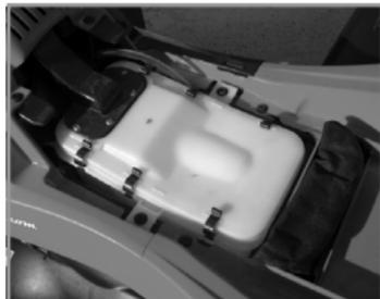
Il vostro quadriciclo è dotato di un filtro aria principale in spugna sintetica protetto da un pre-filtro aria in materiale sintetico.
