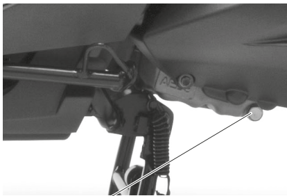
Vite di drenaggio (2)
