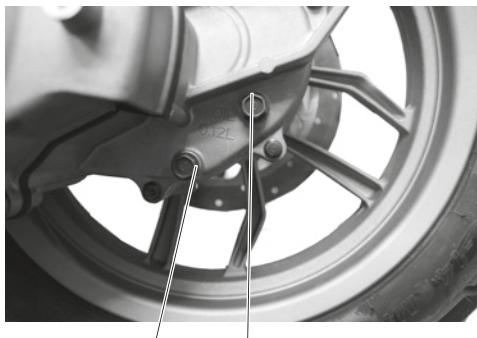
Vite di drenaggio (1)
