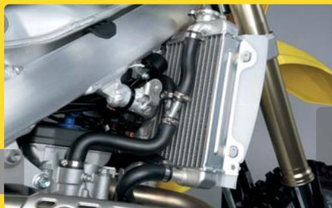
Rivisto nel passaggio dei raccordi per il liquido e riprogettato nel coperchio della pompa dell'acqua, per un raffreddamento più efficace del 16%.
