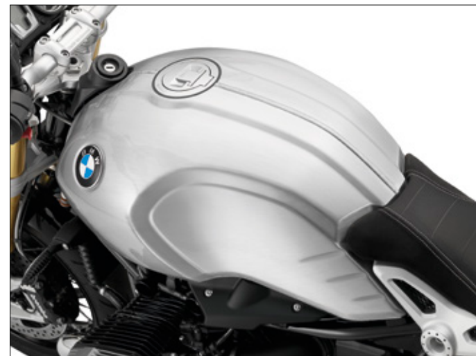
Allestimento optional: raffinato serbatoio in alluminio spazzolato, disponibile con saldatura centrale levigata o a vista. (immagine esemplificativa che ritrae il modello R nineT)
