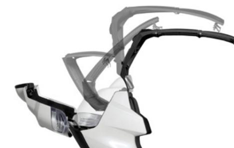
Il Modular Protection System (brevettato) consente di riporre il tetto nel baule posteriore in pochi istanti, per configurare la protezione di Adiva in base al meteo e alla voglia di libertà.
