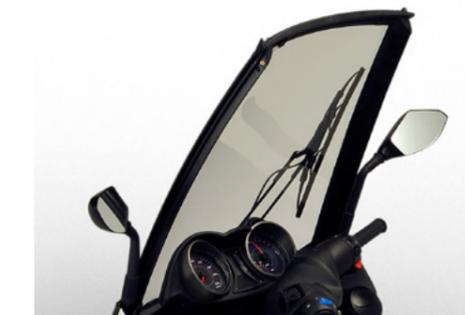
L'ampio parabrezza anteriore, resistente ai raggi UV e dotato di tergicristallo, garantisce un'ampia visibilità in ogni condizione, permettendo di arrivare a destinazione sempre perfetti.
