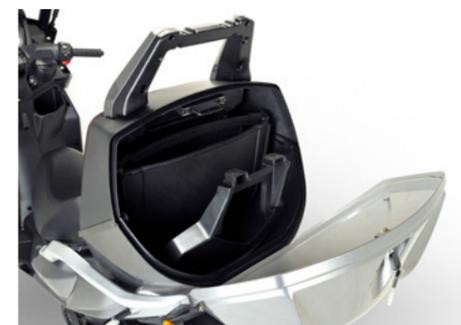
Il baule posteriore in tinta da 40 litri offre un ampio volume di carico per ospitare una borsa di grandi dimensioni, due caschi ed equipaggiamento da pioggia, oppure il tetto ripiegato.
