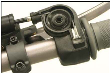
Cable de gas
