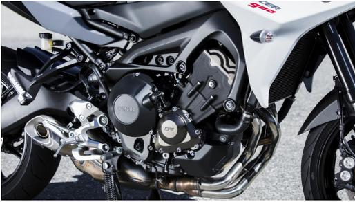
**Compatto e leggero motore da 847 cc a 3 cilindri**
