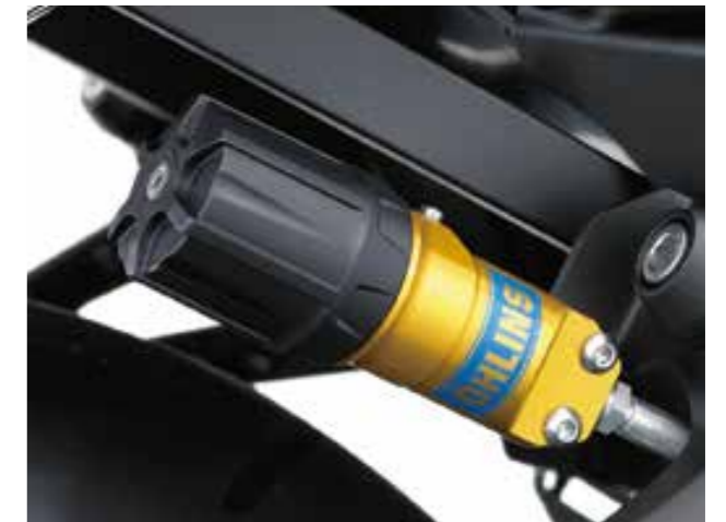
MONOAMMORTIZZATORE ÖHLINS TTX39 CON SERBATOIO SEPARATO E REGISTRO REMOTO DEL PRECARICO *
