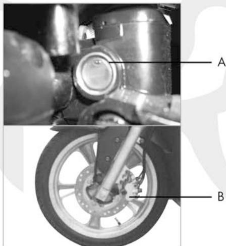
**ATTENZIONE:** Sostituire il pneumatico quando la profondità del tassello è uguale o inferiore a 3mm.
