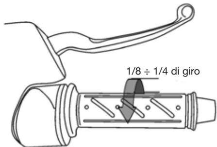
Se dopo 3-4 secondi il motore non si avvia ruotare leggermente la manopola dell'acceleratore ( $1/8 \div 1/4$  di giro). Nel caso lo scooter sia rimasto fermo per alcuni giorni il motore potrebbe non partire immediatamente. In questo caso è necessario ruotare leggermente l'acceleratore e ripetere la procedura di avviamento più volte.
