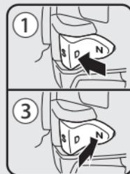
Leva del cambio DCT (NC750XD solo versione III ED)
