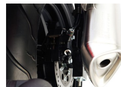
PINZA FRENO POSTERIORE Pinza a 2 pistoncini contrapposti.
