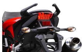
LUCI POSTERIORI A LED Luci posteriori a LED e parafango posteriore removibile.
