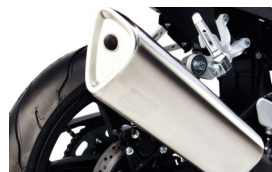
SILENZIATORE Il terminale di scarico è realizzato in acciaio inossidabile.
