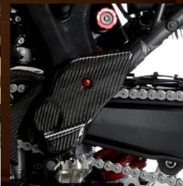
**Ammortizzatore** con nuova molla e nuova taratura idraulica per adattarsi perfettamente alla guida in fuoristrada. Rimane invariato il sistema di precarico originale che è ora dotato di manopola in alluminio anodizzato ricavato dal pieno.
