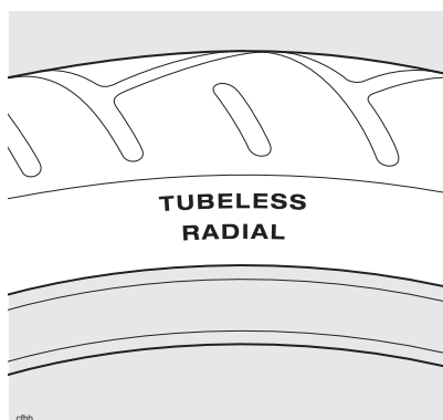
Contrassegno tipico sullo pneumatico - Tipo tubeless
