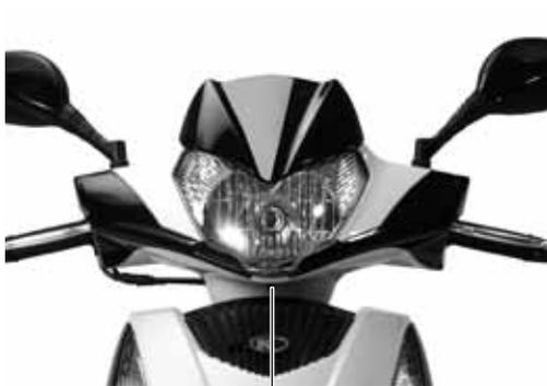
Vite di regolazione (sotto il faro)
