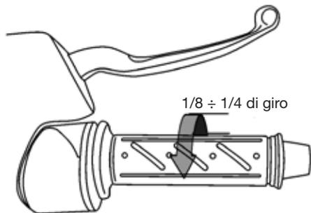
Se dopo 3-4 secondi il motore non si avvia ruotare leggermente la manopola dell'acceleratore ( $1/8 \div 1/4$  di giro).
