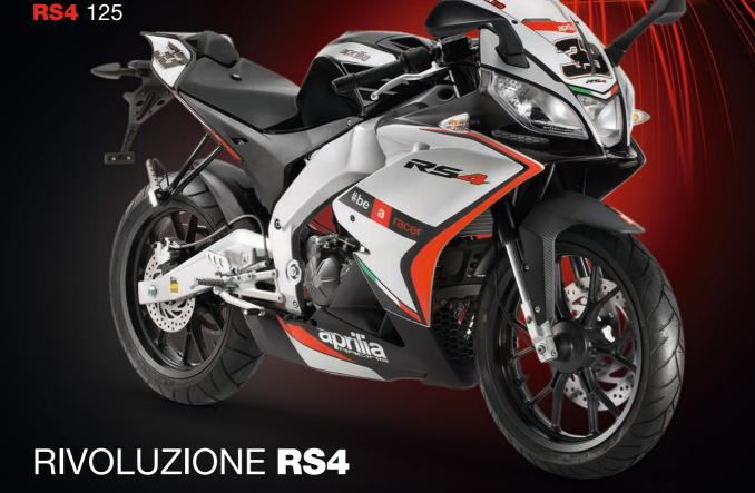
RS4 125 - PER LA PRIMA VOLTA CON MOTORE 125 CC QUATTRO TEMPI CON INIEZIONE ELETTRONICA, 4 E DOPPIO ALBERO A CAMME IN TESTA, ANCORA PIÙ TECNOLOGICO, ECOLOGICO E PARCO NEI CON RS4 50 - CON MOTORE DUE TEMPI DI ULTIMA GENERAZIONE PER PRESTAZIONI AL VERTICE DELLA CATEGORIA. SCEGLI LA MOTO SU MISURA PER TE E PARTI SUBITO ALLA GRANDE!
