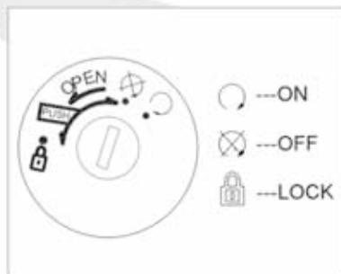
Posizionare la chiave di avviamento nella posizione "ON" prima di avviare il motore.
