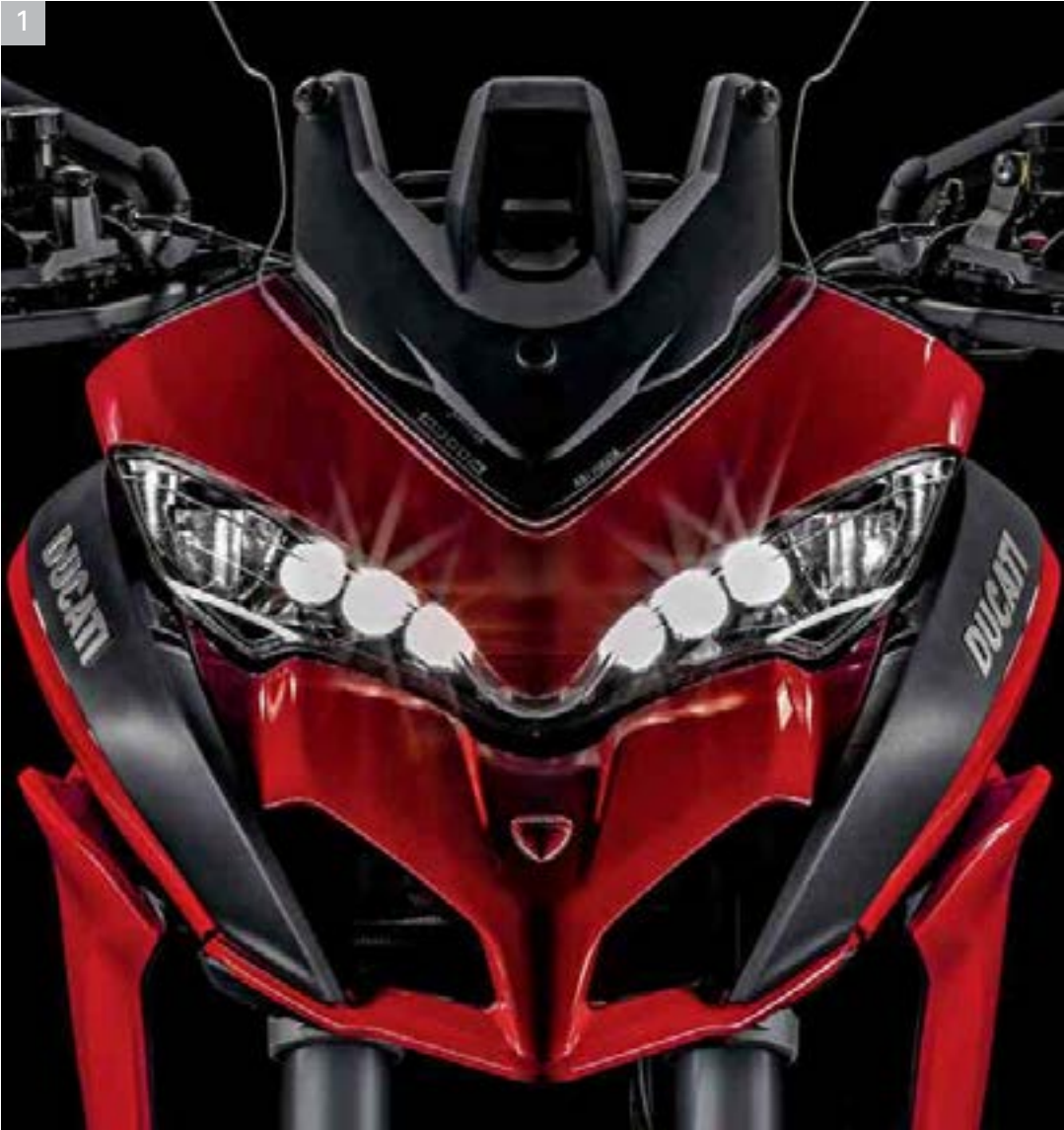
1 Proiettore full-LED con Ducati Cornering Lights (DCL)
